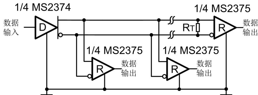
终端电阻和电容值大多由实验测定，根据不同的系统，取值也会不同。例如，终端电阻  $R_T$  一定不能超过传输线特征阻抗的 20%，一般取值范围是 80Ω 到 120Ω。
